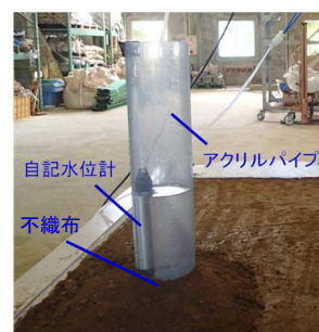
写真 1 簡易透水試験状況
