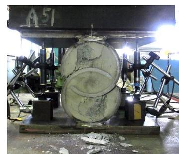
キーワード 鋼管矢板基礎, 立体骨組解析, 縞鋼管高耐力継手, 実物大継手試験, 正負交番荷重
