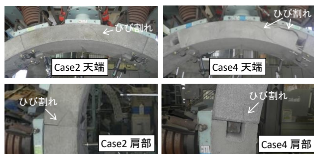
図7 荷重低下時の覆工模型の状況 (Case2,4)
