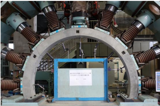
図1 大型トンネル覆工模型実験の状況
