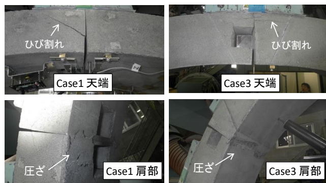
図6 荷重低下時の覆工模型の状況 (Case1,3)
