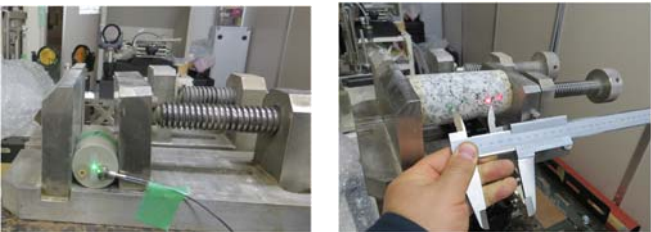
写真-1 透過波測定状況 写真-2 表面波測定状況
