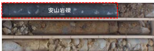
写真-3 ボーリングコア②
