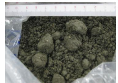
写真-1 採取した脱水処理土
