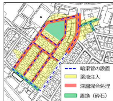
図-1 地盤改良工の適用箇所
