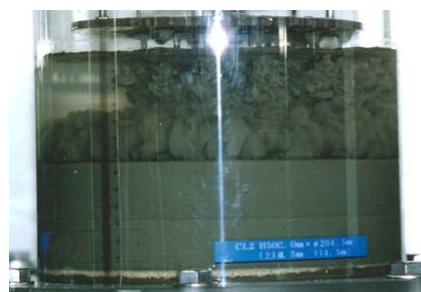
写真-1 多層沈降実験の投入状況
