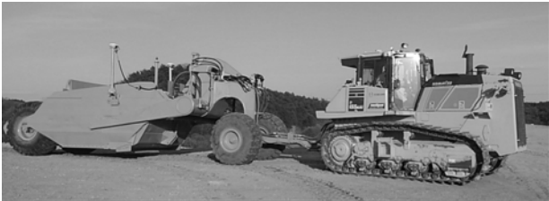
写真-1 ブルドーザー被牽引式スクレーパー 表-1 23SB 諸元
