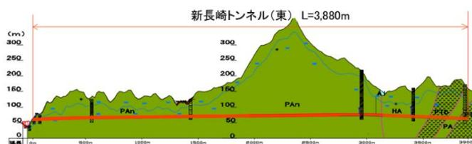
図-1 新長崎トンネル地質縦断面図
