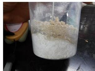
Fig. 7 ④砂薬液混合物
