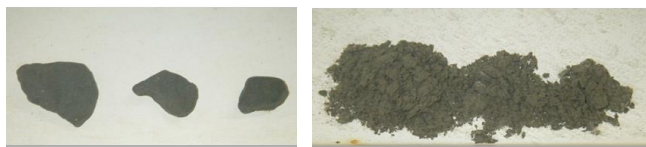
写真-3 浸水崩壊度試験（24時間）実施前後状況
