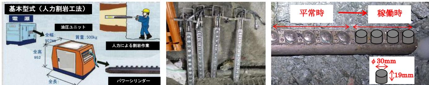
図-3 ロックスプリッターによる人力割岩工法
