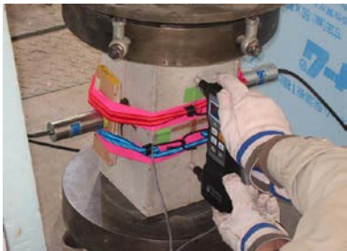
写真-1 超音波伝播速度の測定状況
