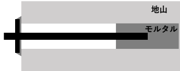
図-4 先端定着概要図
