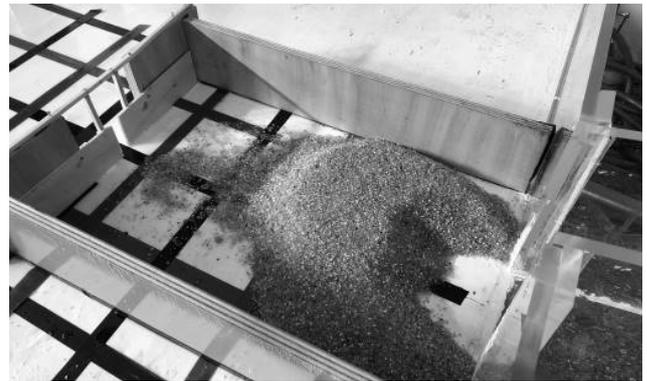
写真-2 堰上げ効果による土砂処理 (捕捉状況) の例
