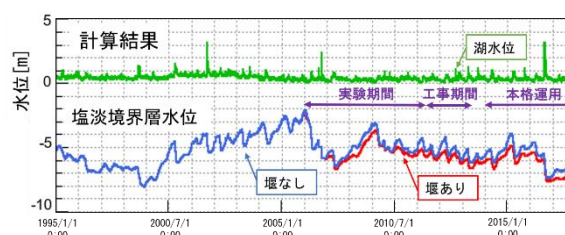
図-4 堰の有無による塩淡水境界層水位の比較
