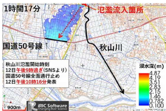
図3 国道50号線を越える直前の氾濫流浸水状況
