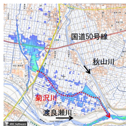
図6 排水工夫を行った場合での計算結果（図5との比較）
