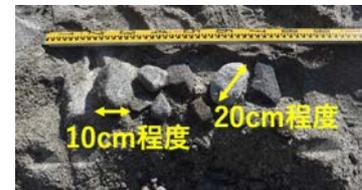
図6 沈砂池排出土砂
