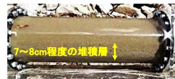
図5 堆積層の形成 ( $\phi 300$ )
