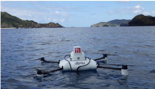
写真-1 水面浮体型ドローン SWANS
