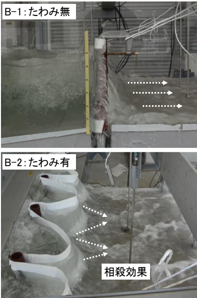
写真1 防波柵下流側の様子
