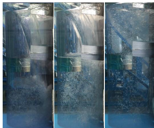
写真 2 マンホール内の流況 ( L/D=19.4, i=0, t/d=0, H/d=2.31 )
