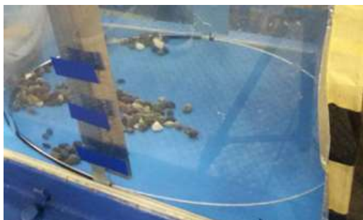
写真 2 マンホール内の流況( d/D=1.51 , case5)
