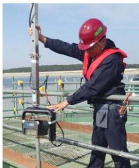
写真-1 音響カメラの外観
