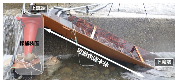
図-1 V 形断面可搬魚道と採捕装置
