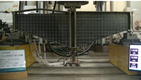
b) U-20-320（試験体中央変位 12.0mm）
