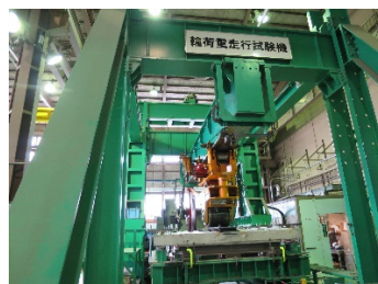
写真-1 輪荷重走行試験機
