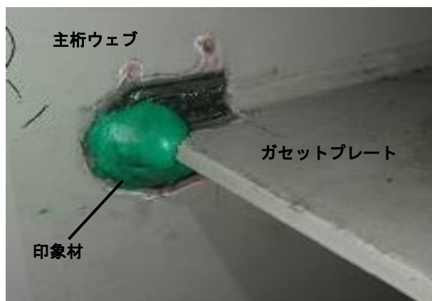
写真-2 印象材によるUIT深さ計測
