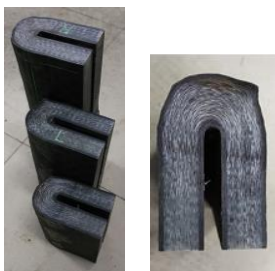
図 7 試験後の FRP 補剛材
