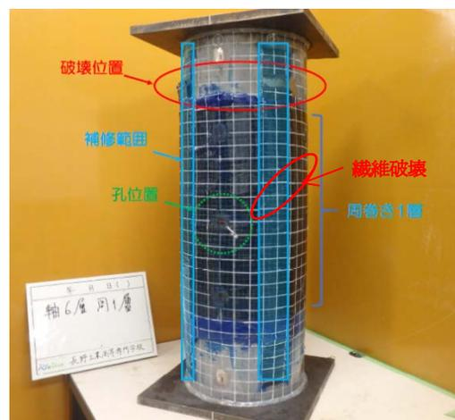
図-3 補強後の試験体 R15-6-1
