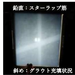
写真-9 X線撮影試験 (G2桁)
