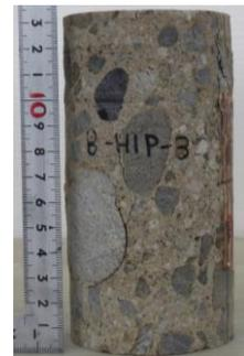
図-3 圧縮試験の供試体
