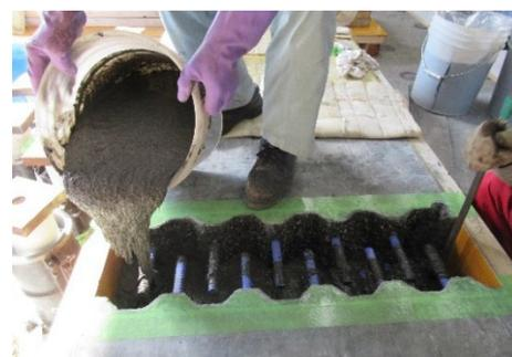
写真-1 UHPFRC の打設状況
