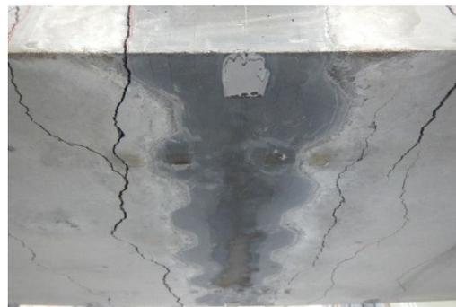
写真-3 破壊後のひび割れ発生状況
