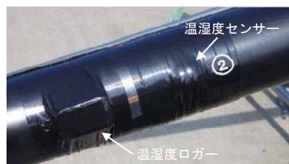
写真-3 温湿度計設置状況
