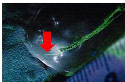
図 9 切削調査結果（集中箇所 X）
