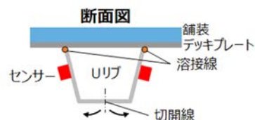
図 5 側面配置センサの 2 次元への展開
