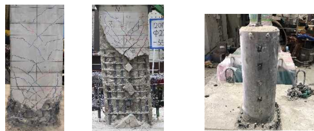
(a) NORMAL-RC (b) CH-UBRC 図-4 載荷側面の様子 (載荷振幅 55\text{mm} )
