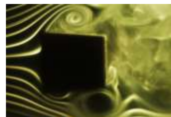
図-5 TYPE3 の流れの可視化画像 ( \theta=5^\circ, V_r=1.7, 2\eta/D=0.10 , 変位最下点)
