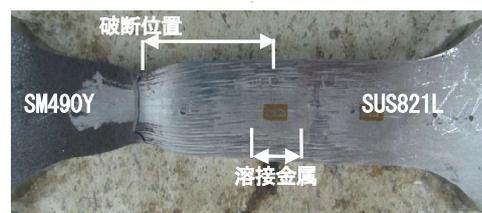
図2 ケース6の破断位置(引張試験)
