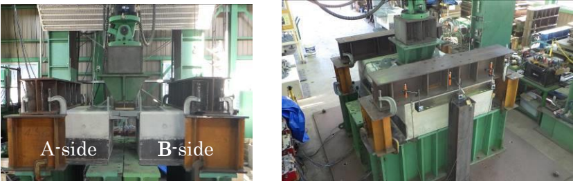
写真-1 試験状況(左：疲労試験, 右：静的載荷試験)
