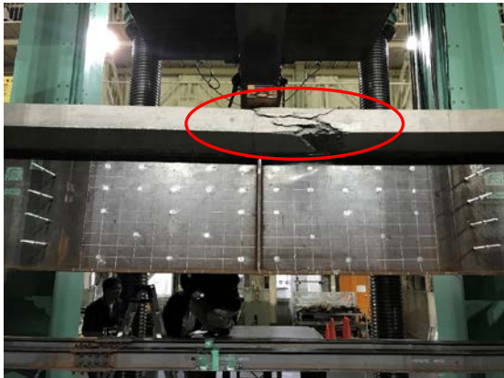
図 3 試験体の破壊状況
