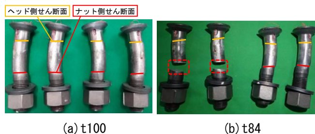
図-4 試験後のボルト
