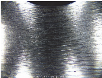
図 6 母材の研削条痕(d16-1)
