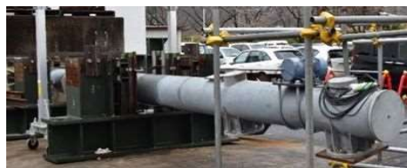
図-2 疲労試験システム
