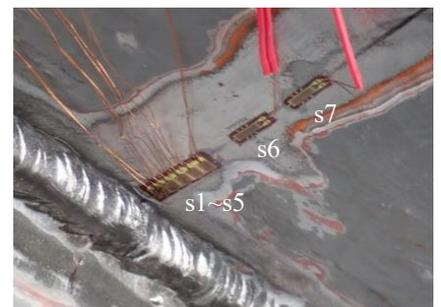
図-3 ひずみゲージ設置状況例
