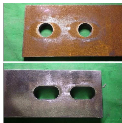
写真-2 すべり面（試験後）
