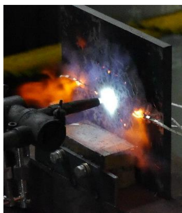
図-2 鋼板加熱実験の様子
