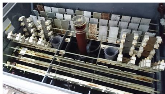
写真-1 環境促進試験の様子
