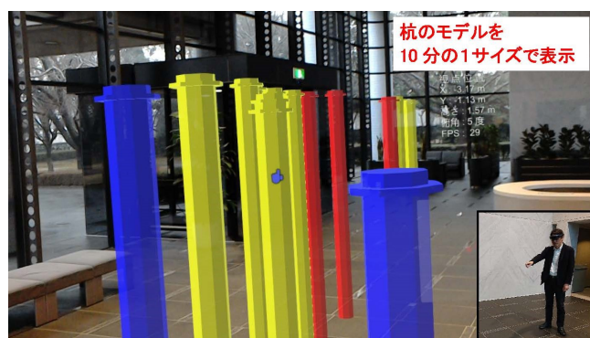
図 5 建設予定の土木構造物の可視化
