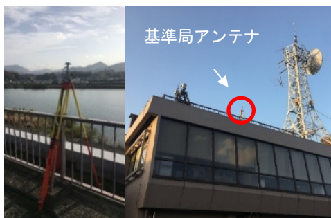
図-1 基準局の設置状況
