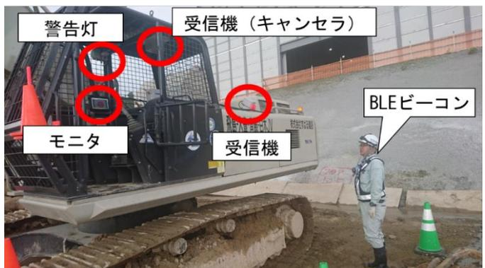
図6 重機接近警告システム
